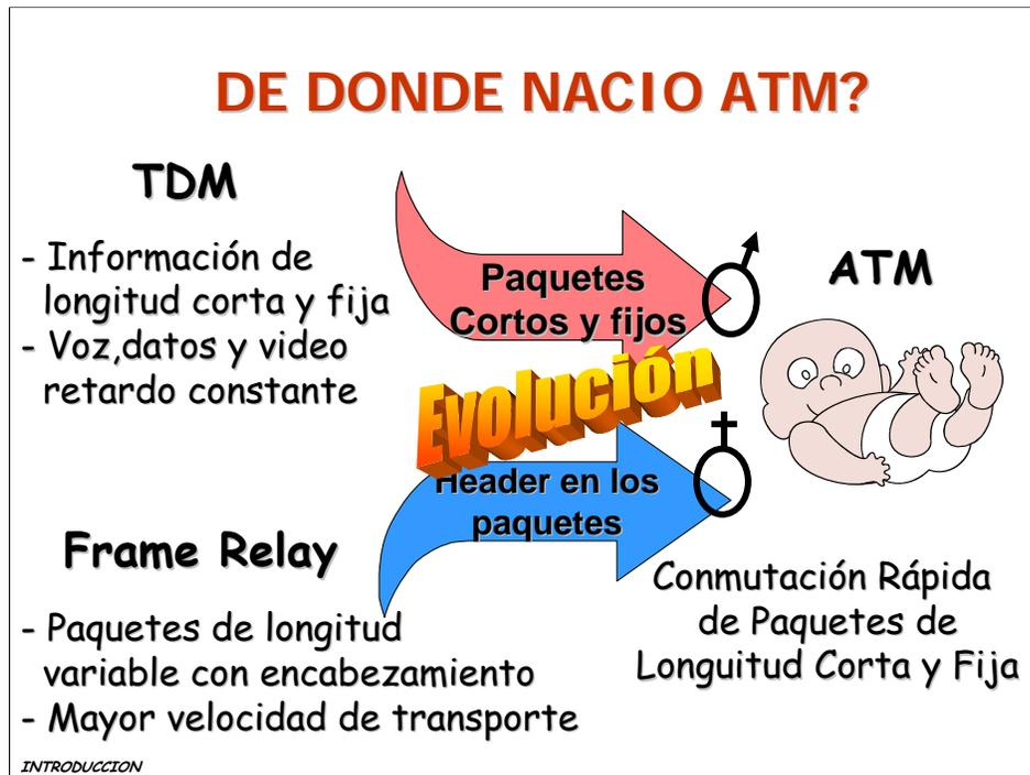
La tecnología ATM o Modo de Transferencia Asíncronico es una evolución de los métodos anteriores de transporte de información, la cual aprovecha las mejores características de cada una de ellas para lograr la mayor eficiencia en el uso del ancho de banda y para transportar cualquier tipo de tráfico sin importar su naturaleza.
